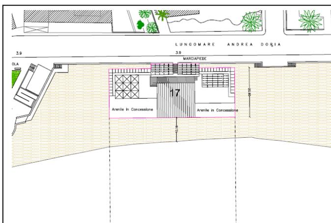
La struttura è interamente realizzata in legno, con fondazioni in pali di legno conficcati nel suolo. oltre la stagione balneare vengono rimosse tutte le attrezzature relative alla balneazione (cabine, pedane, ecc.), mentre permane la struttura destinata al ristorante.
