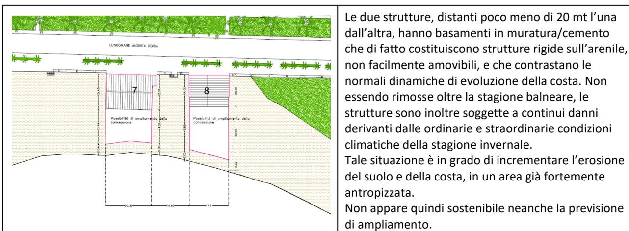
**Azioni di piano (L2, L3):** Conversione della struttura in muratura/cemento con struttura in legno con fondazione in pali di legno, qualora si renda necessaria la manutenzione straordinaria delle strutture; nessuna rimozione oltre la stagione balneare
