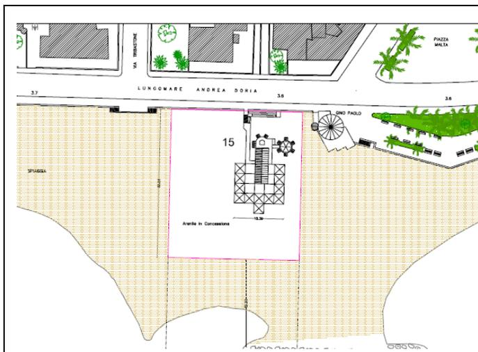
Si ipotizzano impatti in termini di erosione del suolo e della costa, causati dalla rilevante occupazione di suolo delle strutture (circa 450 mq calcolata su base orto fotogrammetrica), che non vengono rimosse oltre la stagione balneare + pavimentazione in autobloccanti in cemento probabilmente posati sul letto di sabbia poco drenanti.
