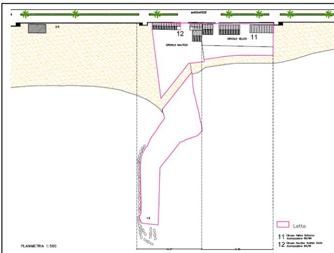
L'area si presenta in erosione per la presenza del molo con struttura in cemento e lunghezza di circa 100 mt che impedisce il normale trasporto di sedimenti lungo la direzione prevalente delle correnti marine (ovest-est). La superficie totale cementificata è pari a circa 250 mq. I danni alla struttura causati dalle mareggiate invernali determinano la necessità di continua manutenzione con ulteriore manomissione dei luoghi (cementificazione, ingresso di mezzi pesanti sulla spiaggia, ecc.)
